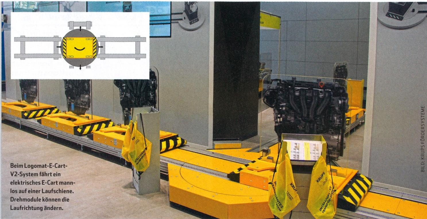
Beim Logomat-E-Cart-V2-System fährt ein elektrisches E-Cart mannlos auf einer Laufschiene. Drehmodule können die Laufrichtung ändern.
