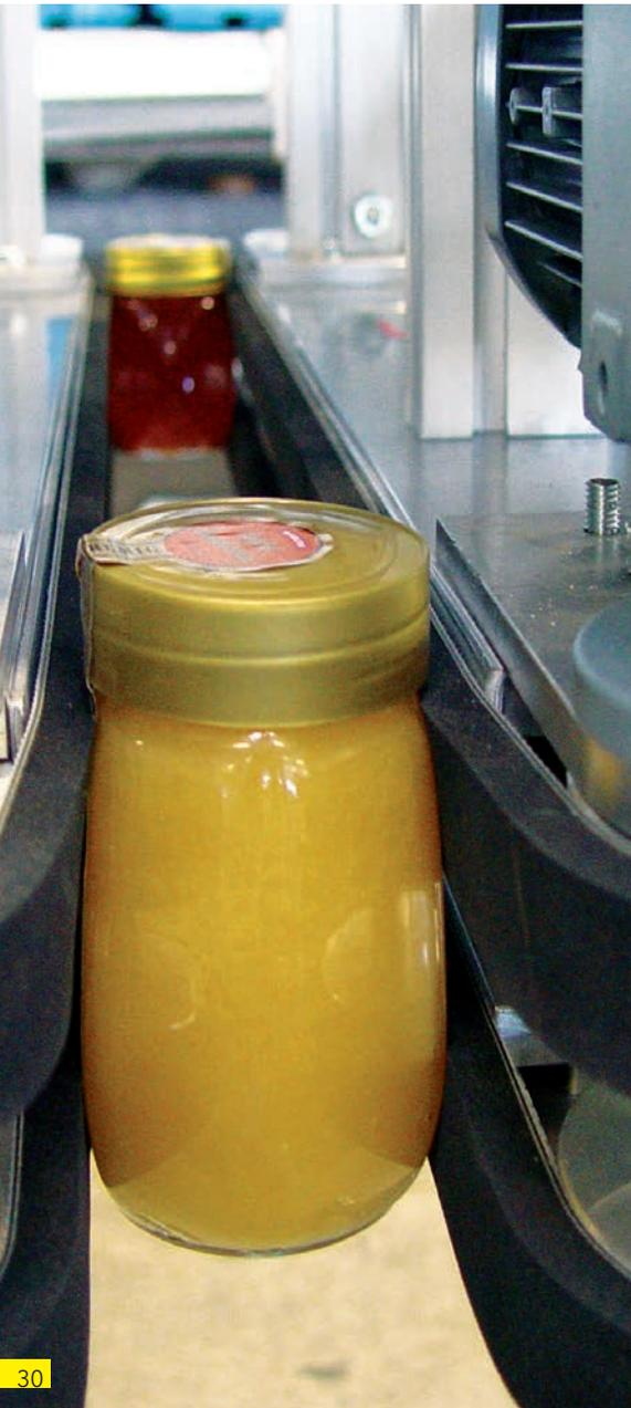
Klemmgurtförderer werden in Anlagen zum Markieren, Beschriften und Etikettieren eingesetzt. Um die Unterseite oder Böden der Gebinde zu bearbeiten, werden diese Gebinde seitlich zwischen 2 weichen Gurten schonend eingeklemmt und transportiert. Dadurch ist die Unterseite des Gebindes frei zugänglich.
