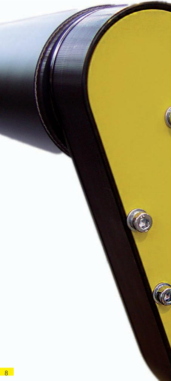
Kompaktes, stabiles Band mit einer Bauhöhe von nur 35 mm, besonders geeignet als Zu- oder Abführband an Maschinen mit beengten Platzverhältnissen. Verwindungssteifer Rahmen aus eloxiertem Aluminiumprofil. Die beidseitig über die gesamte Profillänge laufenden Nuten sind für M8-Nutensteine ausgelegt und dienen zur Befestigung von weiteren Anbauteilen am Rahmen.
