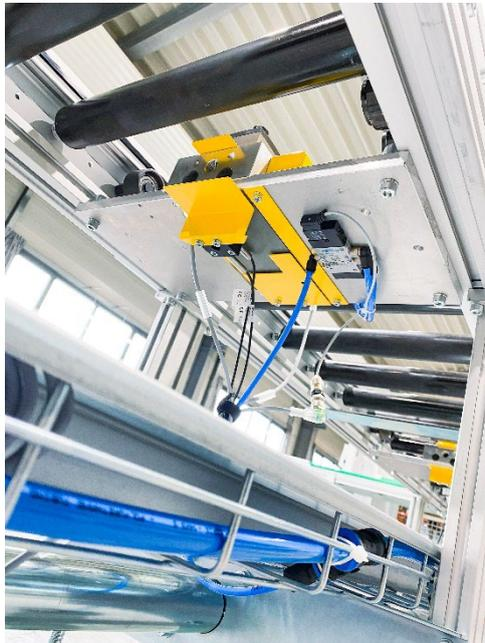
*Pneumatischer Stopper im LOGO!MAT Rollenförderer mit Sensorik und Verschlauchung.*
