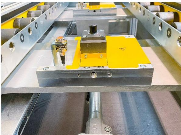
*Der kompakte, pneumatische Stopper im direkten Vergleich.*
